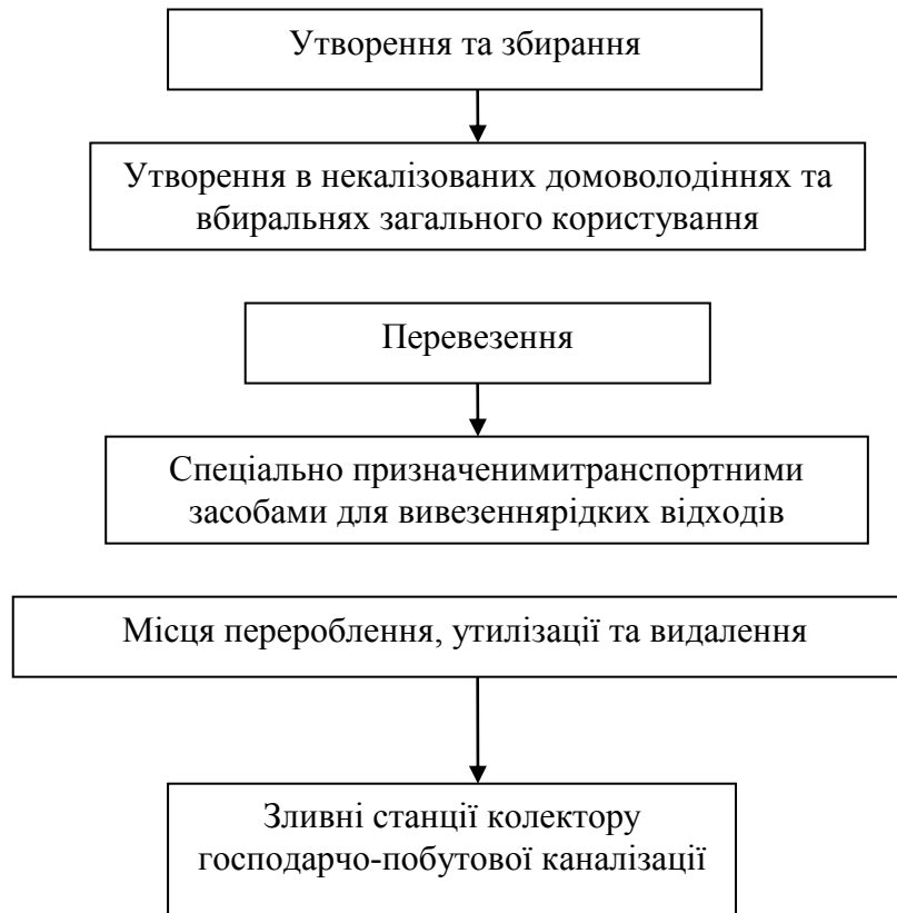
Рисунок 2.12 – Система поводження з рідкими відходами
