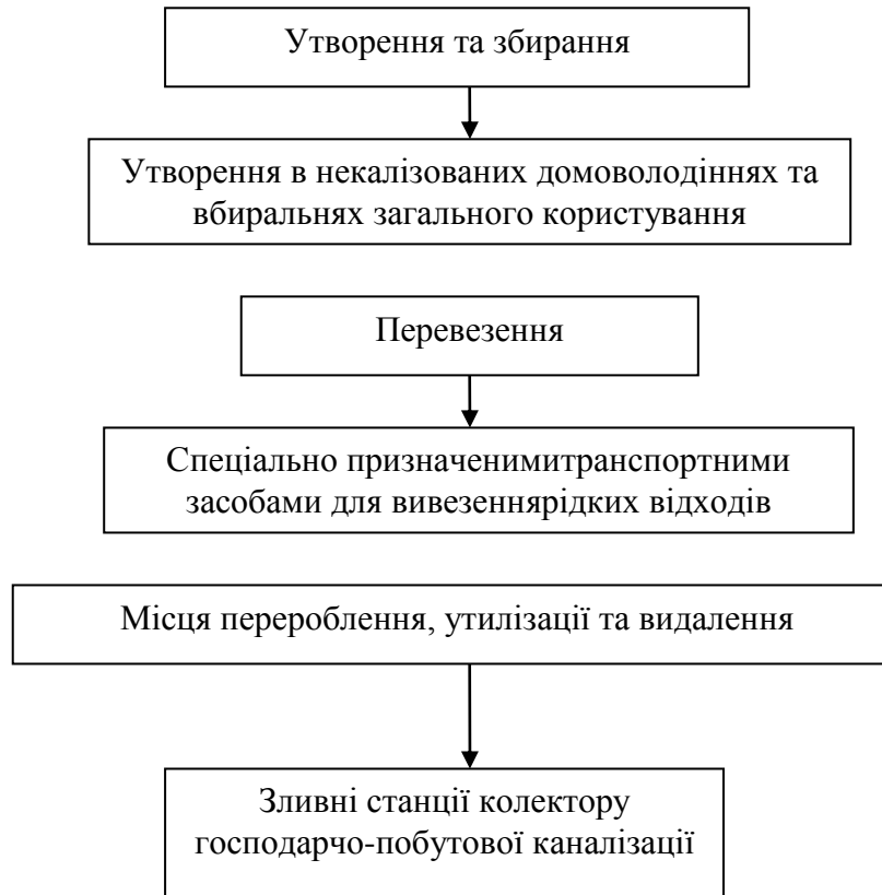
Рисунок 2.12 – Система поводження з рідкими відходами
