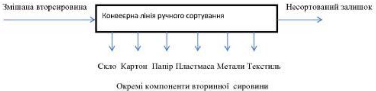
Рисунок 2.3 – Структурно-технологічна схема ручного сортування роздільно зібраної вторинної сировини
